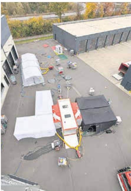
Der AB Dekon-V ist in einen schwarzen Bereich (vor der Dekontamination) und einen weißen Bereich (nach der Dekontamination) aufgeteilt.
