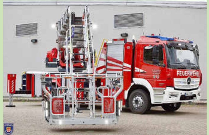
Nun stationiert am Standort der Freiwilligen Feuerwehr Bad Bergzabern: vollelektrische Drehleiter des Typs L32A-XS electric von Rosenbauer.
