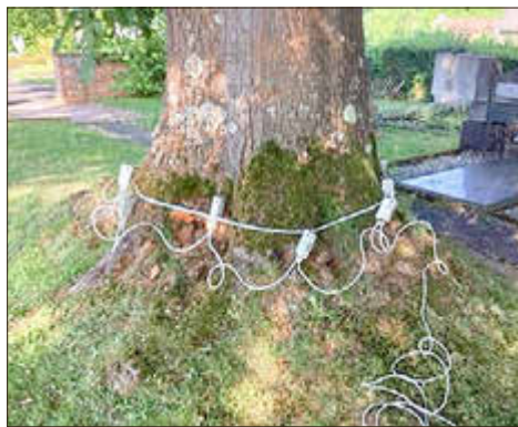
Foto zeigt die Untersuchung mittels Schalltomographie
