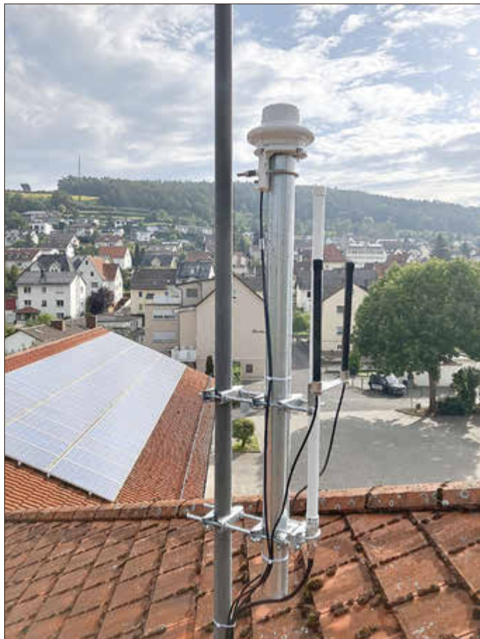
Der Sensor ist auf einem Fach in Bad Salzschlirf angebracht und misst den dortigen Niederschlag. Foto: Landkreis Fulda
