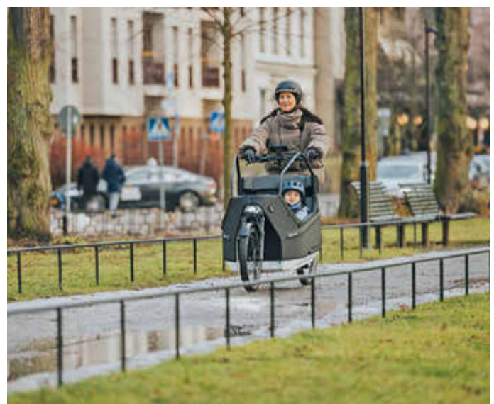
Für mehr Sicherheit unterwegs sorgt das eBike ABS. Es verhindert, dass das Vorderrad blockiert und hilft beim Bremsen auf rutschigen Untergründen wie nassem Asphalt oder losem Schotter. Foto: Robert Bosch GmbH/akz-o
